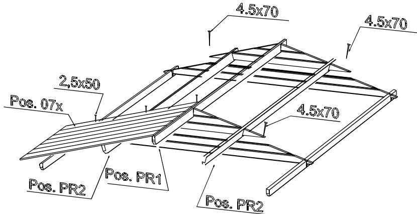
**POZOR:** Pokud nejsou stěnové trámy řádně natlačeny na sebe bez mezer, nebude horní stěnový trám na stejně úrovni se štíty. V tomto případě byste měli poklepem zatlačit stěnové trámy podle potřeby dolů, nebo ohoblovat štíť či bočnici na o něco nižší rozměr.
